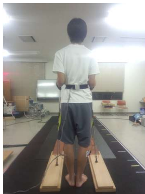
図 1 : NW 時の床反力と筋活動の計測風景
