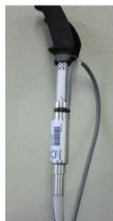
図 3 計測用ポールのトランスデューサーを装着したポール
