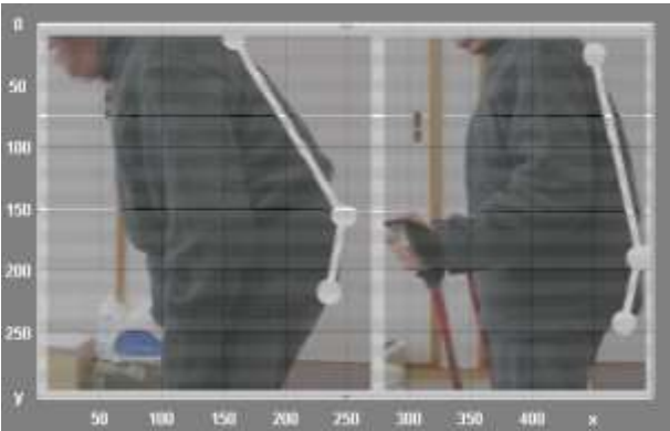
図2 体幹屈曲の測定方法（仙骨後面と第1胸椎と第5胸椎を結ぶ線のなす角を参考とした）
