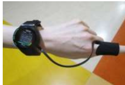
図1：NISSEI 光電式脈拍モニター パルネオ HR-60
